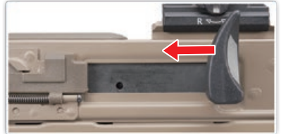
Tirar de la maneta de carga la bloqueará hacia atrás y abrirá la tapa del puerto.
