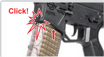
Inserte el cargador hasta que escuche click.
