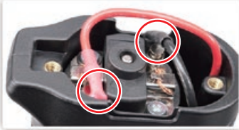
無作動 檢查馬達連接線(需卸下底板)。
