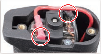
無作動 檢查馬達連接線(需卸下底板)。
