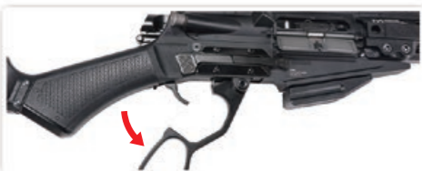
Gire la palanca hacia adelante para retirar el cerrojo y abrir la tapa del puerto.
