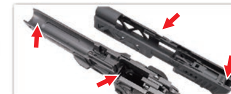
頻繁に摩耗する箇所に適量のシリコンオイルを塗布して潤滑する。
