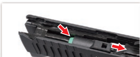
將活塞座裡的活塞橡皮噴塗適當砂油保養。
