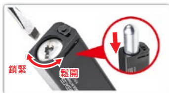
鎖緊 鬆開 使用6mm六角扳手工具鬆開CO2氣瓶旋蓋，放入CO2氣瓶，再鎖緊旋蓋。
