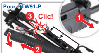
Pour GTW91-P 1.Retirez la goupille du rail inférieur. 2.Poussez le rail inférieur vers l'avant et tirez vers le haut depuis l'arrière du rail inférieur pour le retirer. 3.Connectez la batterie jusqu'à ce qu'elle s'enclenche.
