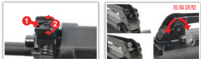
順時鐘旋轉：上升準星尖位置。 逆時鐘旋轉：下降準星尖位置。 近距離覘孔(大) / 遠距離覘孔(小) 風偏調整鈕(照門左右調整)。
