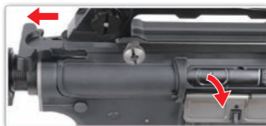
Tirer sur le levier de chargement va tirer la culasse en arrière et ouvrir le capot latéral.
