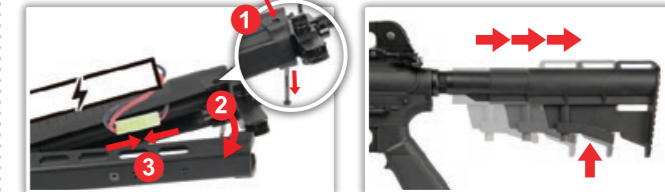
1. ピンを抜いてください。 2. アッパーハンドガードを取り外してください。 3. バッテリーのコネクターをカチンというまで押し込んでください。 ストックの位置を調節するために、ボタンを押ししてください。(5段階)
