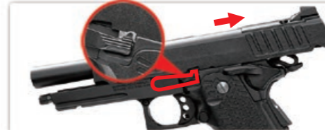
1. スライドを後ろにずらして切り欠きをあわせませす。 2. スライドストップを抜き取ります。
