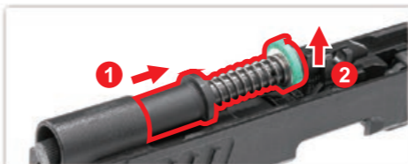
1. スプリングプラグを引き抜きます。 2. スプリングプラグとガイドロッドを取り外します。
