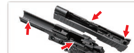
Appliquer du silicone pour lubrifier les zones de frottement.
