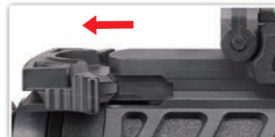
Halando la manija de carga llevará el cerrojo atrás y abrirá la cubierta.
