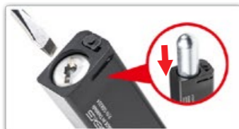
6mm六角レンチで緩め、CO2カートリッジを入れ、底部のスクリューを締めます。
