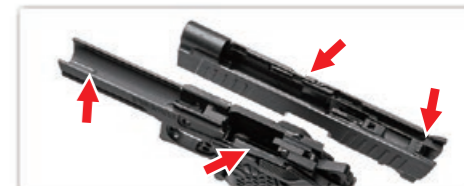
頻りに摩耗する箇所に適量のシリコンオイルを塗布して潤滑する。
