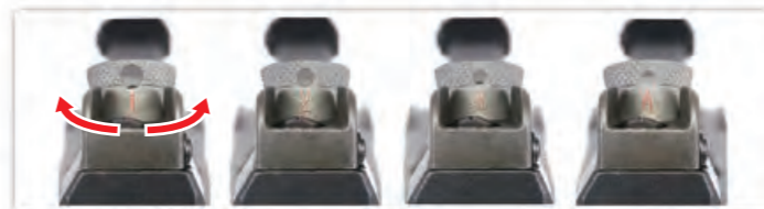
依目標距離遠近旋轉調整大小不同的瞻孔，越遠的目標使用越小的瞻孔。
