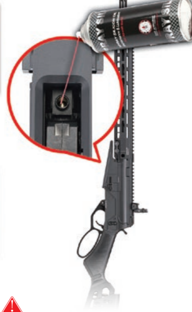
Asegúrese de tener la varilla hacia abajo y llegando hasta el final. Retire los balines obstruidos.
