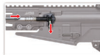
確認通槍條斜面朝下直插到底，移除堵塞BB彈。
