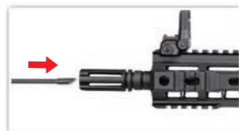
將上旋器撥回釋放位置，由槍管前端插入通槍條。
