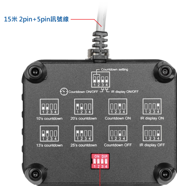
波段開關-倒數時間選擇、倒數功能開關、日/夜間模式切換
