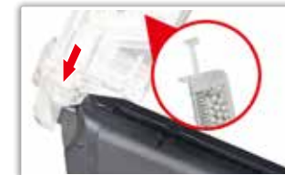
Mettez les billes dans le chargeur.
