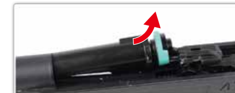
スプリングプラグとガイドロッドを取り外します。
