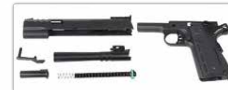
分解後、適切に洗浄し、メンテナンスのためにシリコンオイルをスプレーすることができます。
