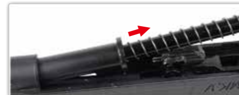
Separe el muelle del conector.
