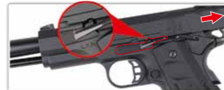
將滑套拉至後方並對齊半圓缺口並且取出滑套制動銷。
