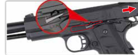
1. Retenez la glissière en arrière. 2. Retirez l'arrêtoir de culasse.
