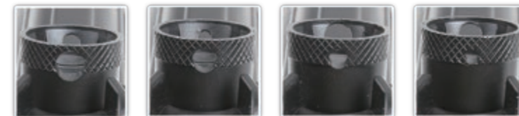
依目標距離遠近旋轉調整大小不同的瞳孔，越遠的目標使用越小的瞳孔。
