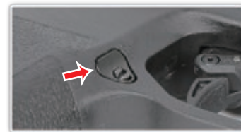
Retournez le pistolet et tournez la tête de vis sur l'arrêtoir de chargeur.
