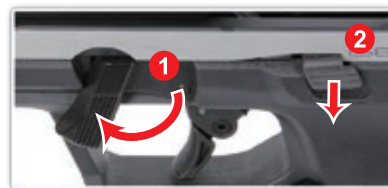
Gire la palanca de desmontaje y presione el tope deslizante.
