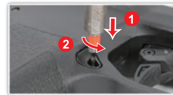
Utilisez un tournevis à tête plate, et tournez à 90 degrés dans le sens antihoraire.
