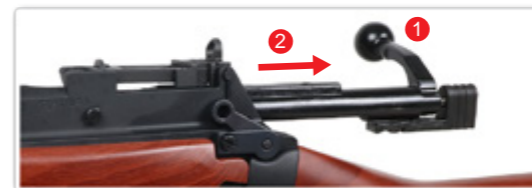
Culasse verrouillée (avant chargement) Levier de chargement bloqué.
