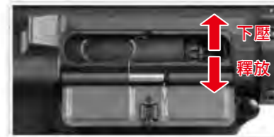
向上或向下推動內腔調整彈道。 下壓 釋放
