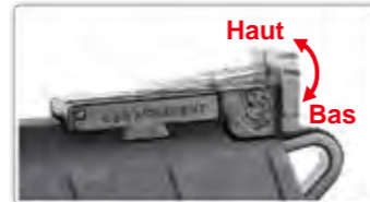
Sens horaire : élever la visée. Sens antihoraire : baisser la visée.
