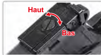
Tournez la vis de réglage sur le cran de mire pour régler l'élévation.
