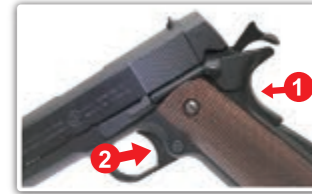
1. Maintenez enfoncé la pédale de sûreté. 2. Appuyez sur la queue de détente.
