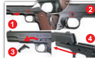
1. Maintenez la culasse en arrière. 2. Poussez sur l'arrêteur de culasse. 3. Retirez l'arrêteur de culasse. 4. Retirez la culasse vers l'avant.
