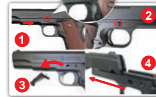
1. Sostenga la corredera hacia atrás como desmostrado en la foto. 2. Empuje la palanca del retenedor de la corredera. 3. Saque la palanca del retenedor de la corredera. 4. Empuje la corredera hacia adelante.
