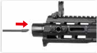
將HOP下壓撥回歸放置位置・由槍管前端插入通槍條。
