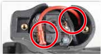
無作動 檢查馬達連接線(需卸下底板)。
