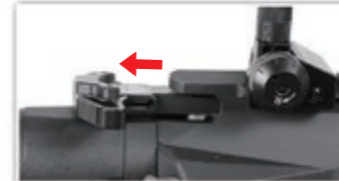
Tirer sur le levier de chargement va tirer la culasse en arrière et ouvrir le capot latéral.
