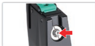
バルブを押し、カートリッジ内にCO2ガスが残っていないことを確認してから取り外してください。
