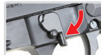
テイクダウンレバーを下に回します。
