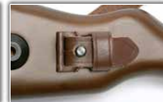
Tirer sur la bretelle pour faire reposer la grenouillère dans la culasse comme ci-dessus.
