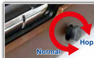
Tourner la bague hop-up pour ajuster la trajectoire des BBs. Un hop excessif peut causer le bourrage des BBs.
