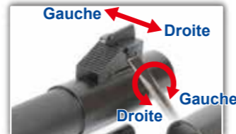
Ajuster la vis changera le point d'impact en dérive.
