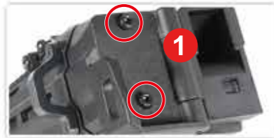
1.先使用内六角(6mm)拆下槍托後兩顆螺絲。
