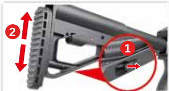
1. 向前推開位於槍托下方的插銷。 2. 向上（一格）或向下（六格）調整底板位置。
