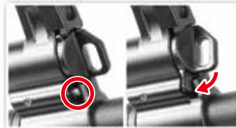
將插銷後推，逆時針旋轉取下瓦斯管前蓋。
