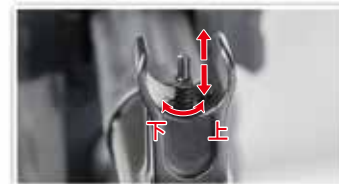
使用尖嘴鉗旋轉調整星尖的高度。
