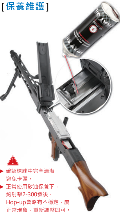
將通槍條插入內管，旋轉通槍條帶出髒汙，重複以上步驟直到內管清潔。
