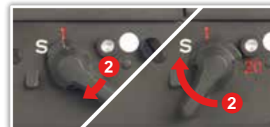
2.セレクターレバーをセミオートかフルオートにセットしてください。
