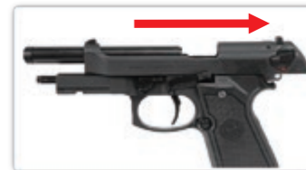
將滑套拉至後方使擊錘後定。
