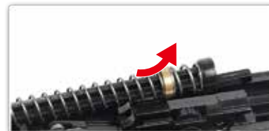
Avec précaution faites pivoter le guide de ressort et retirez-le lentement.
