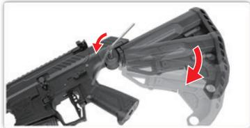
使用5毫米內六角扳手擰鬆六角螺絲以調整
