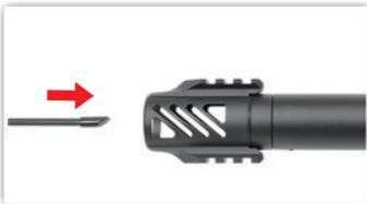
ホップアップダイアルをノーマルの位置に戻して、インナーバレル先端部から、クリーニングロッドを挿入してください。
