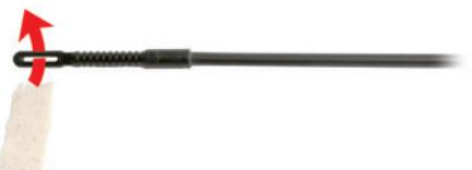
1. Versez quelques gouttes d'huile de silicone ou de téflon sur un morceau de tissu que vous accrocherez sur la tige de débourrage.
