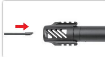
Gire el dial de Hop-up a posición normal e inserte la varilla por la bocacha dentro del cañón.
