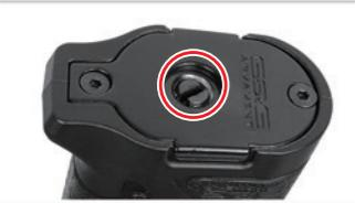
**Ajuste el tornillo cuando los engranajes se tornen chilleones.**
