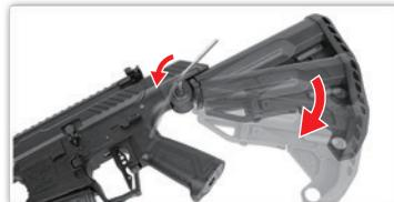
Используйте шестигранный ключ на 5 мм, чтобы ослабить винт и отрегулировать угол наклона приклада.
