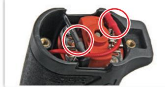
Не работает. Проверьте контакты проводов на моторе.
