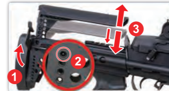
1. Empuje la palanca hacia arriba para desbloquear mejilla. 2. Presione el pasador para mover la mejilla. 3. La mejilla se puede levantar o presionar abajo.
