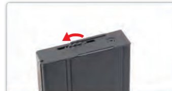
Gire el engranaje en la parte inferior del cargador para atiesar el resorte. Esto hará que los balines alimenten la recámara.
