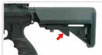
Appuyer sur le levier pour déverrouiller la crosse.
