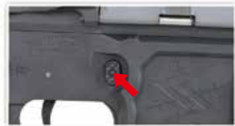
Appuyez sur le verrou situé de chaque côté de la réplique pour retirer le chargeur.
