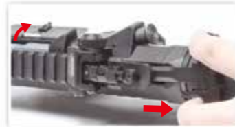
Tirer sur le levier de chargement va tirer la culasse en arrière et ouvrir le capot latéral.
