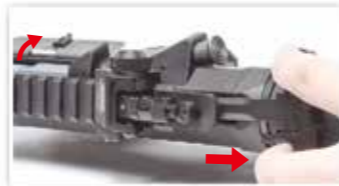
チャージングハンドルを引いて、ボルトを戻して、ポートカバーを開けます。
