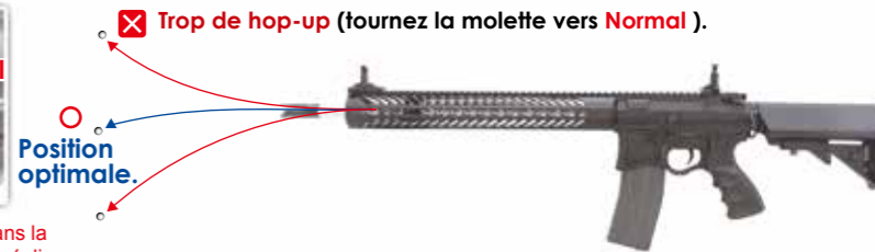
❌ Pas assez de hop-up (tournez la molette vers Hop), ou trop de hop-up (tournez la molette vers Normal).
