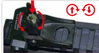
フロントサイトの上下調整のために、ボタンを押してください。 時計回り：着弾点を上げます。 反時計回り：着弾点を下げます。
