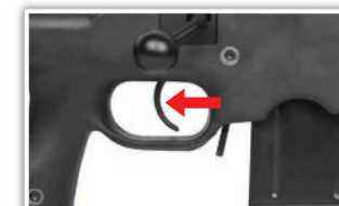
Actionner la queue de détente pour tirer.
