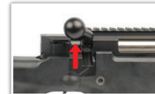
Pivoter le levier de chargement vers le haut.
