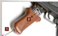
1. Отвинтите фиксирующий винт в основании pistolетной рукоятки 2. Снимите рукоятку.
