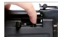
Передвигайте ползунок хоп-апа вперед/назад чтобы достичь желаемой регулировки.
