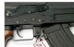
Установите магазин. Он должен плотно встать на место с характерным щелчком.
